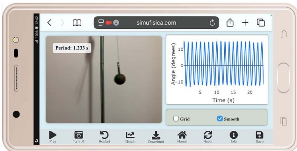
Figura 3.5: Interface do aplicativo Pêndulo Filmado da plataforma SimuFísica ® em execução em um smartphone . A aplicação utiliza visão computacional para detectar automaticamente o movimento do pêndulo e exibir, em tempo real, o gráfico do ângulo em função do tempo, além de estimativas do período de oscilação. Acesso disponível em: https://simufisica.com/simulacoes/pendulo-filmado/ .
